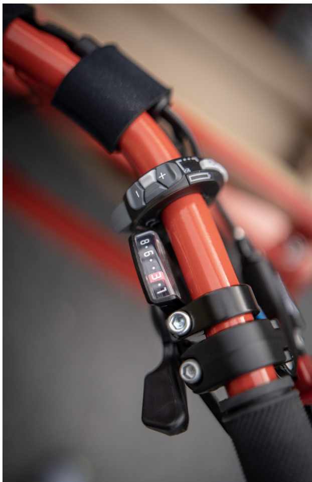
Den eldrivna trehjulingen har ett reglage på styrstängens för att justera elmotorns hjälp.
